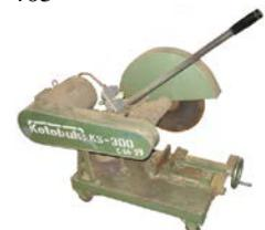
図 6. 高速切断機
