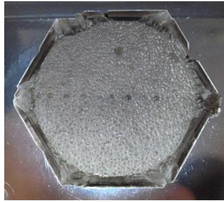
図5. 複数の GaN 結晶を合体させて育成した 2 インチ GaN 結晶
